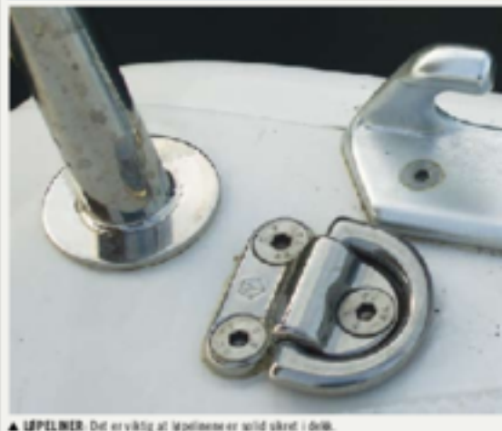
▲ LØPELINER. Det er viktig at løpeleiene er solid skruet i dekk.
