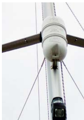
RADARREFLEKTOR: En radarreflektor er påkrevet i alle kategorier, bortsett fra kategori 6.
