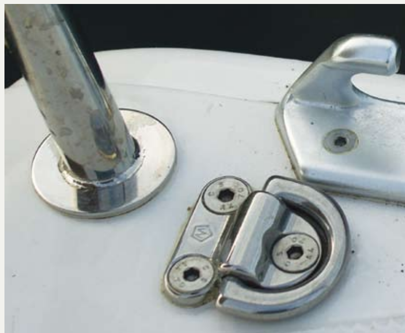
▲ LØPELINER: Det er viktig at løpelinene er solid sikret i dekk.
