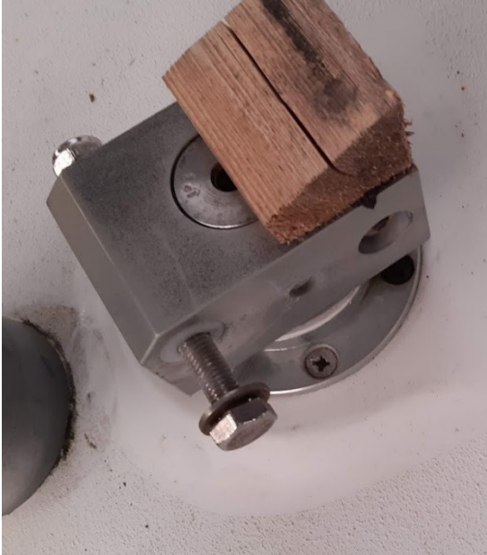
Övre roderlager, inga skador
