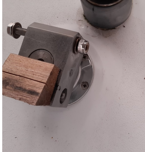
Övre roderlager, inga skador
